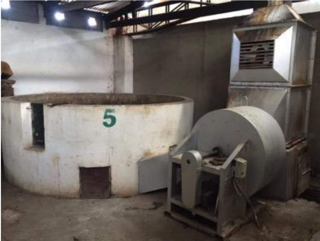
FIGURA 3: SECADORAS DE CARDAMOMO SON UTILIZADAS PARA SECAR EL RAMÓN. CORTESÍA DE CAFINTER.
