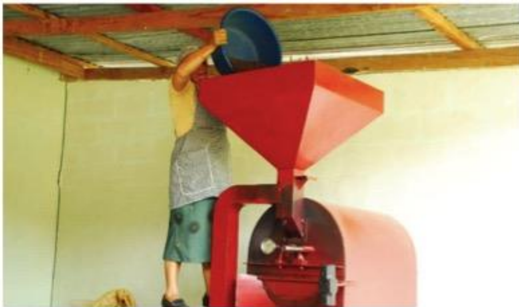
FIGURA 2: UNA TOSTADORA DE CAFÉ ES UTILIZADA PARA UN PROCESO DE PRE-SECADO, Y DESPUÉS LA SEMILLAS SON SECADAS EN PLATAFORMAS Y SECADAS POR EL SOL. FOTO DE FIÓN GÓNGORA.
